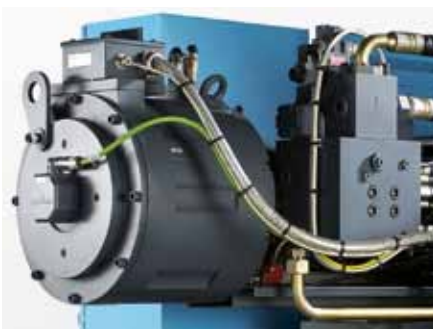
W pełni elektryczny napęd dozowania
