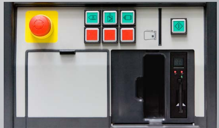
Steuerung mit neuem CompactFlash-Modul
