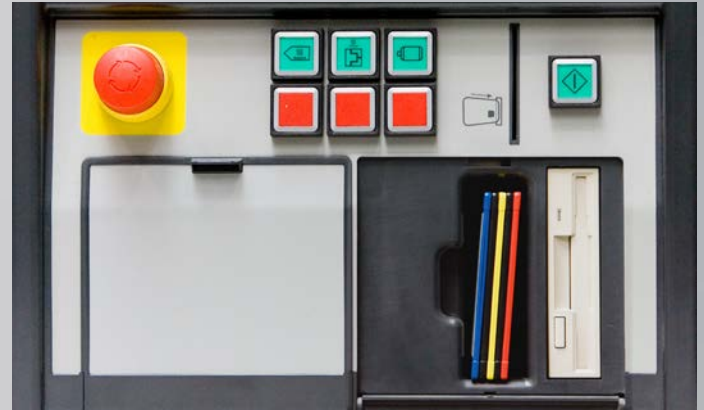
Steuerung mit altem Diskettenlaufwerk
