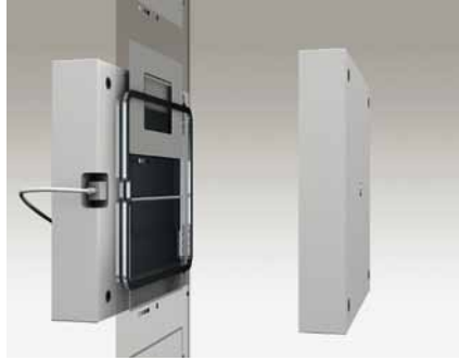
▲ Von links nach rechts: IML- Einlegen des Labels auf der Einspritzseite des Werkzeugs; IMD - Positionieren der Dekorfolie; In einem einzigen Fertigungsschritt entstehen multitouchfähige Displays.
