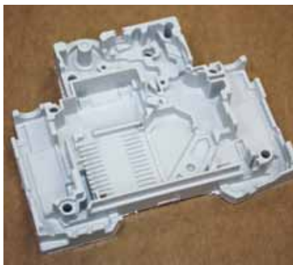
▲ Aus BMC spritzgegossenes Gehäuseteil eines Leitungsschutzschalters vor (links) und nach der Entgratung (rechts).
