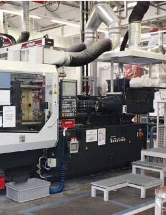
▲ Der Polystopfer zur Materialeinbringung (rechts) sowie die großen Absauganlagen über Stopfer und Werkzeugbereich sind die auffälligsten Unterscheidungsmerkmale zur Thermoplast-Spritzgießmaschine.
