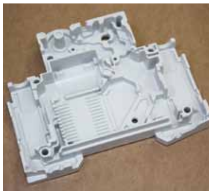
▲ Aus BMC spritzgegossenes Gehäuseteil eines Leitungsschutzschalters vor (links) und nach der Entgratung (rechts).
